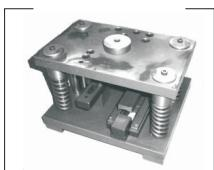
Operação do cunho CX.910 nos aros móveis centrais e laterais para o encaixe das travessas
