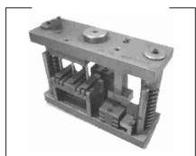
Operação do cunho CX.913 no aro fixo ombreira tri-rail para a união com CX.78
